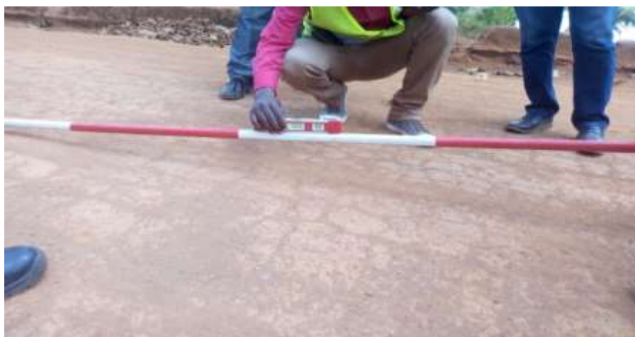
FIGURA 32 PROCESSO DE MEDIÇÃO DE DECLIVIDADES
